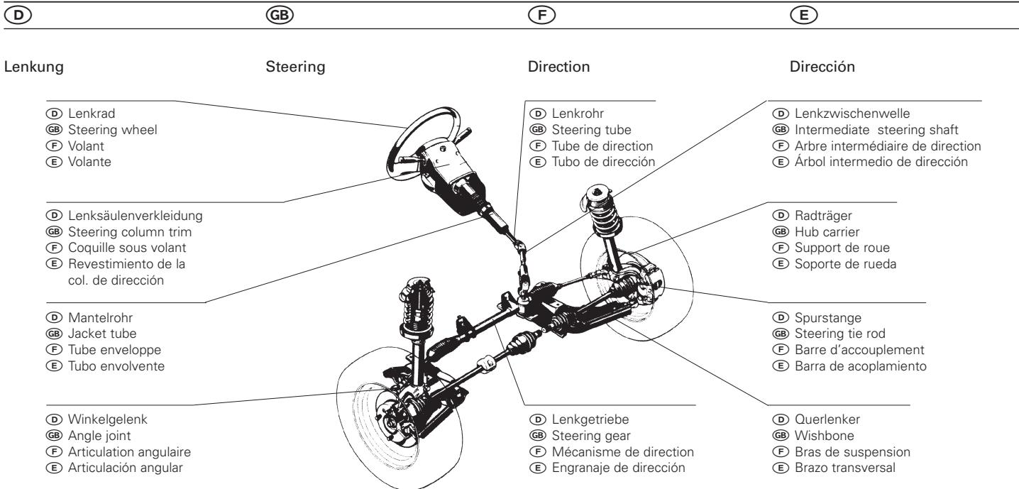
Zur Lenkanlage zählen die Teile, die dazu beitragen, die Drehbewegung des Lenkrades in die Lenkbewegung des Rades umzusetzen.
