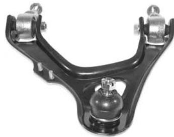
Querlenker sollten leicht und unter Einwirkung von Seiten-, Anfahr- und Bremskräften knicksteif, biege-sicher und dauerhaltbar sein.
