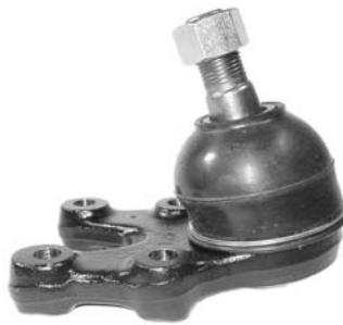
Auf der dem Führungsgelenk gegenüberliegenden Seite befindet sich, im Achsschenkel montiert, das Traggelenk. Es nimmt Kräfte in allen Richtungen auf. Traggelenke können hängend oder stehend eingebaut sein.
