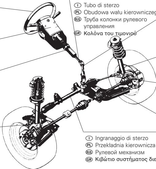
L'impianto sterzante comprende i componenti che consentono di convertire il movimento rotatorio del volante nel movimento sterzante della ruota.
